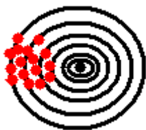
Figur 2: Figuren visar en måltavla där mitten motsvarar en korrekt mätning. De röda prickarna motsvarar de faktiska mätningarna i ett påstått exempel där man har hög reliabilitet men låg validitet, alltså att mätningarna blir väldigt lika men att de mäter fel sak. Baserat på en figur av Teorell och Svensson (2007).
