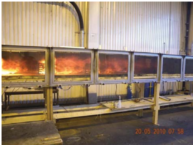
Figur 1 Brandförsök för att validera beräkningsmodell för brandspridning mellan olika objekt.
