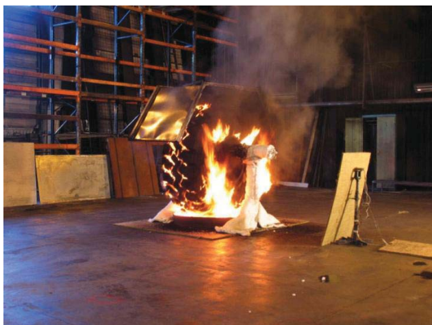
Figur 2 Brandförsök med hjullastardäck där brandeffekten uppmättes.
