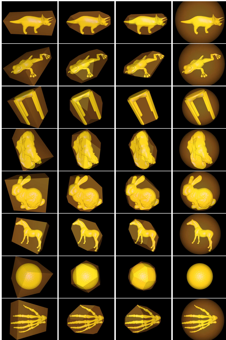
Figur 17: De olika polygonmodellerna samt resulterande AABB (kolumn 1), 14-DOP (kolumn 2), 26-DOP (kolumn 3), och sfärer (kolumn 4). Sfärerna är beräknade med EPOS-26.
