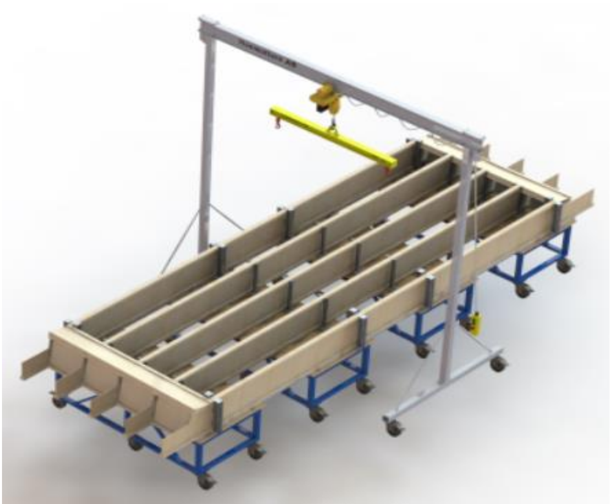
Figur 33: Sammanställning av alla komponenterna för Takmodulen.
