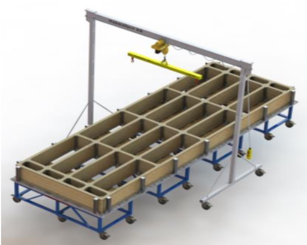
Figur 30: Sammanställning av alla komponenterna för Golvmodulen.
