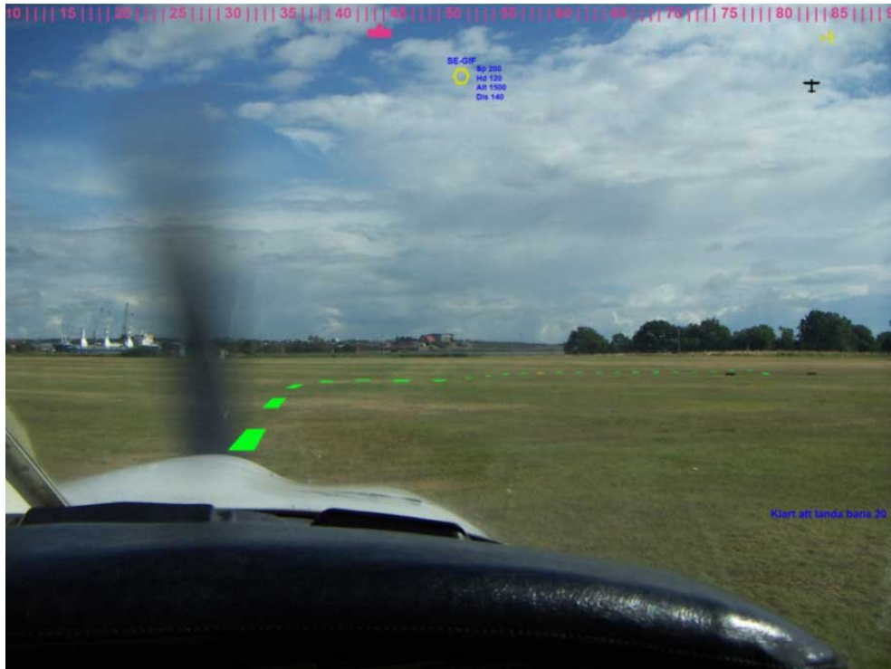
Figur 25: hur piloten kan navigera på marken med hjälp av ATSVIS.
