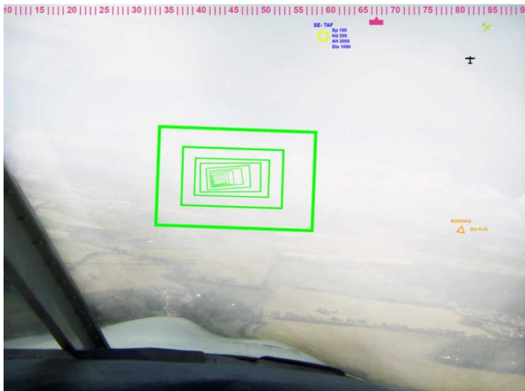
Figur 24: Visar hur ATSVIS hjälper piloten vid dålig sikt att positionera sig och att visa övrig flygtrafik i dess närhet.
